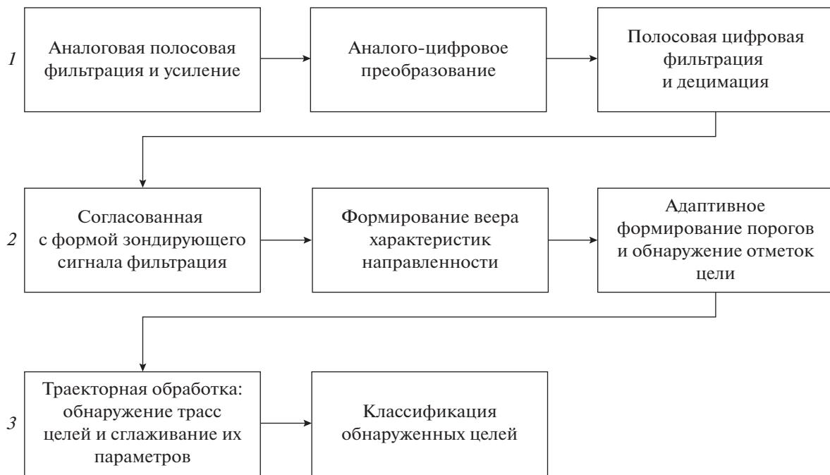
Рис. 2. Блок-схема алгоритма обработки сигналов в ГЛС.
