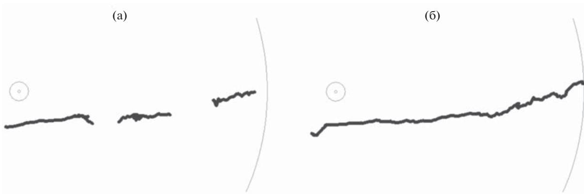
**Рис. 14.** Результаты обнаружения и оценки координат от движущегося отражателя в натурном эксперименте, полученные на выходе алгоритмов (а) – обнаружения одиночных импульсов и (б) – с квазиоптимальным накоплением.
