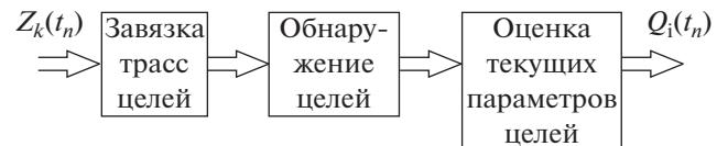
Рис. 13. Блок-схема вторичной обработки информации,  $Q_i(t_n)$  – формуляры обнаруженных целей, содержащие их текущие параметры – координаты и скорость движения цели.
