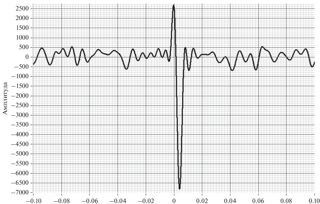
Рис. 2. Инверсия взаимно-корреляционной функции при обработке “фазовых” сигналов.
