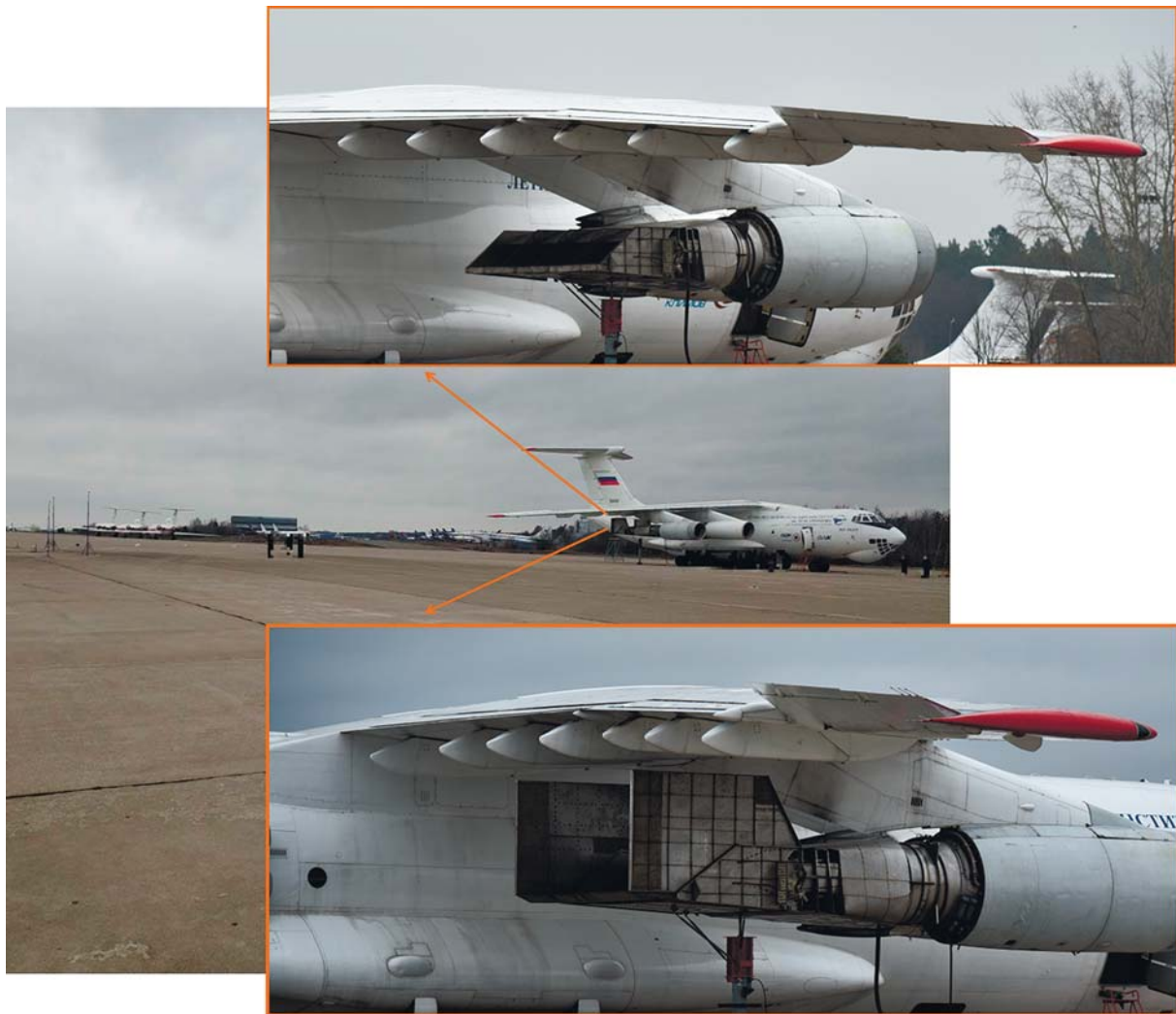
Рис. 1. Наземные стендовые испытания плоского сопла в составе самолета. Крайний правый двигатель самолета оборудован плоским соплом с экранами (внизу) или без экранов (вверху).
