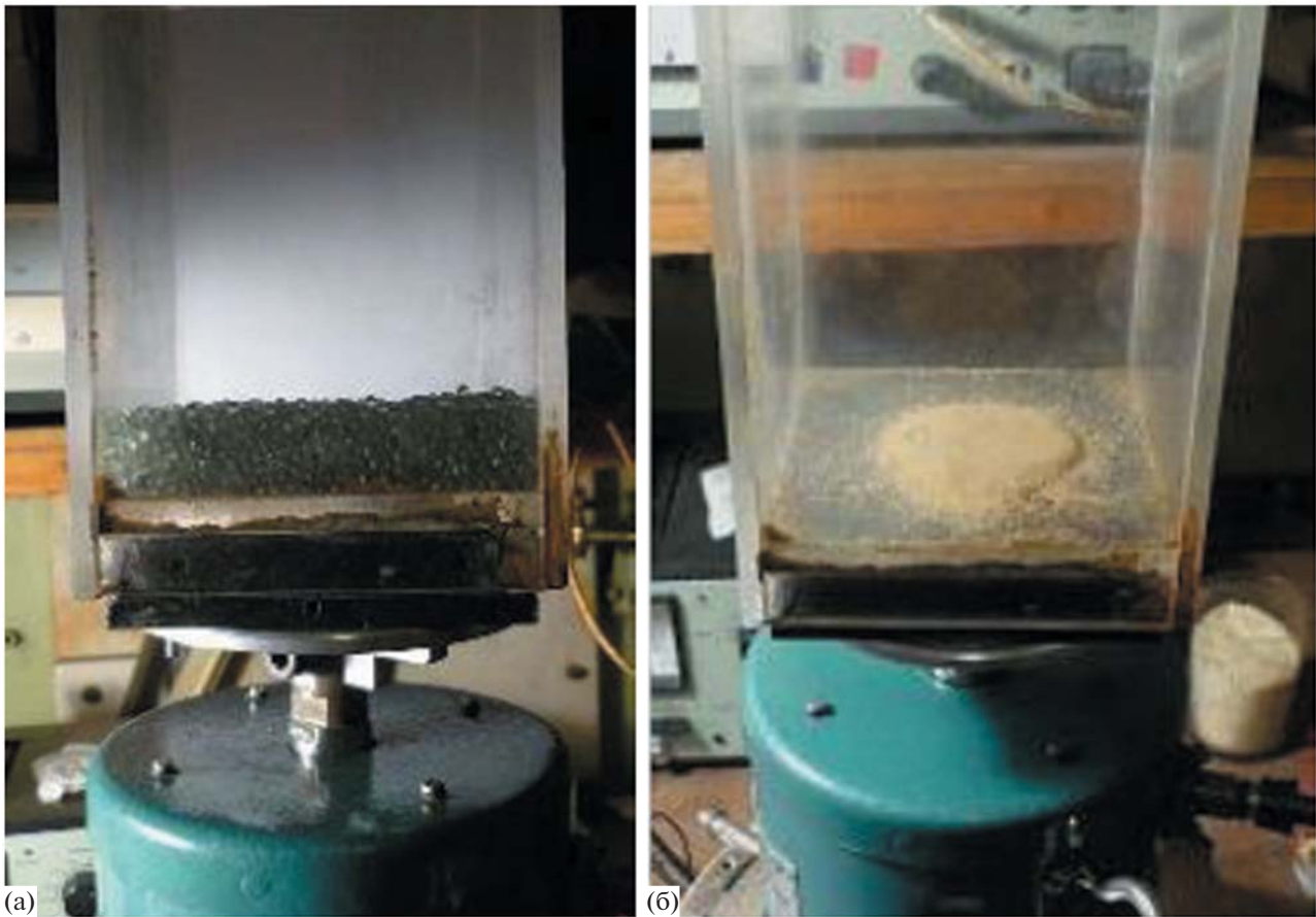
Рис. 1. (а) – Традиционная для исследований система – слой гранулированного материала в вибрирующем сосуде; (б) – новый объект для исследований – плоский кластер , объемно-локализованная, изолированная от боковых стенок гранулированная (сыпучая) структура.
