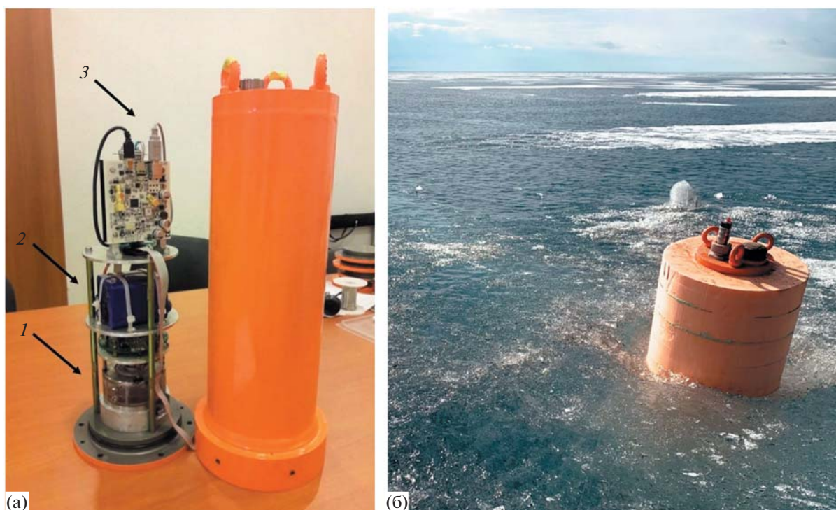
Рис. 10. (а) – Макет вмораживаемого геоакустического информационно-измерительного буя: 1 – воспринимающие сенсоры; 2 – элементы питания; 3 – цифровой регистратор и блок электроники; (б) – рабочий макет вмораживаемого буя на льду озера Байкал.
