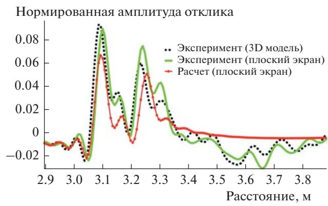
Рис. 13. Сравнение нормированных амплитуд импульсных откликов для конфигурации № 2 (угол наблюдения  $75^\circ$ ).
