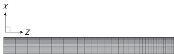
Рис. 5. Распределение расчетных ячеек на поверхности лопасти для сетки 160 тыс. ячеек.
