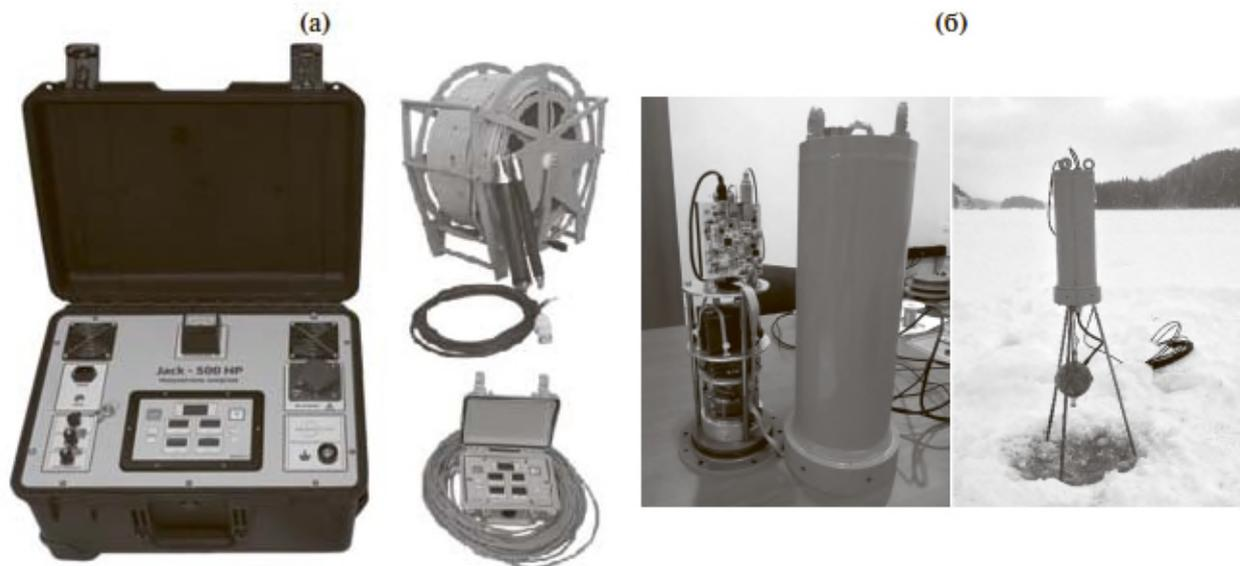
**Рис. 2.** Используемые технические средства: (а) – электроискровой излучающий комплекс (накопитель энергии и спаркер); (б) – гео-гидроакустический измерительный буй ледового класса.
