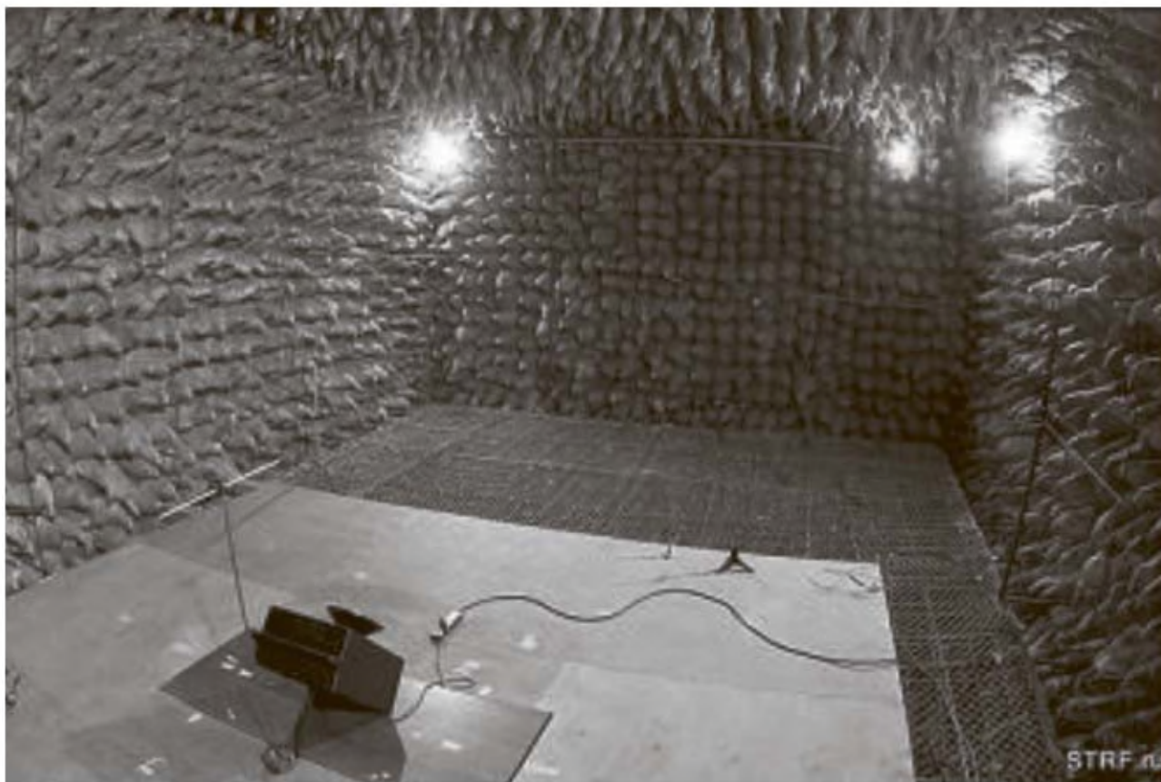
Рис. 2. Общий вид звукомерной заглушенной камеры кафедры акустики МГУ им. М.В. Ломоносова с добавленным конструктивным элементом – настилом из фанерных панелей на подвесной сетчатый пол.
