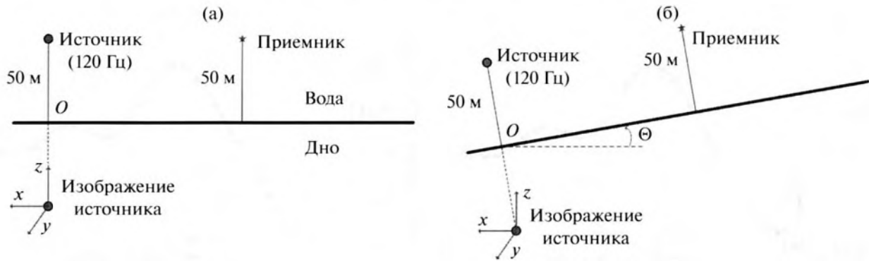
Рис. 5. (а) Геометрия расчетной области для построения эталонного решения. (б) Геометрия области после поворота относительно оси y .
