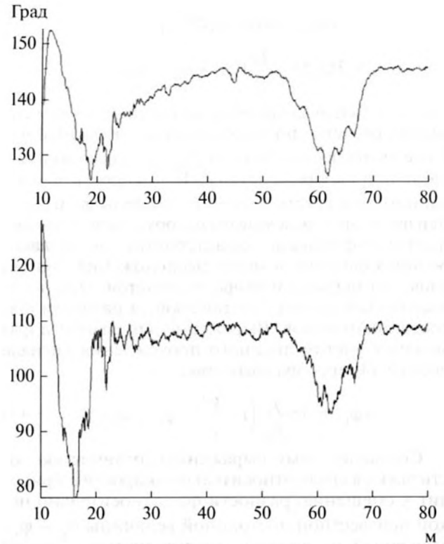
Рис. 4. Разности фаз эхо-сигналов, измеренные между соседними отсчетами (вверху) и между отсчетами, разнесенными на два интервала квантования (внизу).
