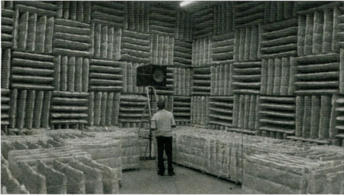
Рис. 1. Фотография заглушенной камеры ПНИПУ.
