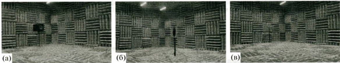
Рис. 8. (а) Низкочастотный источник вблизи стены камеры, (б) среднечастотный источник в центре камеры, (в) высокочастотный источник вблизи стены камеры.
