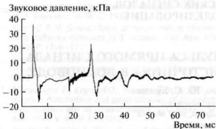
Рис. 1. Осциллограмма звукового давления, зарегистрированного на расстоянии 10 м от срабатывания петарды на глубине 4 м.
