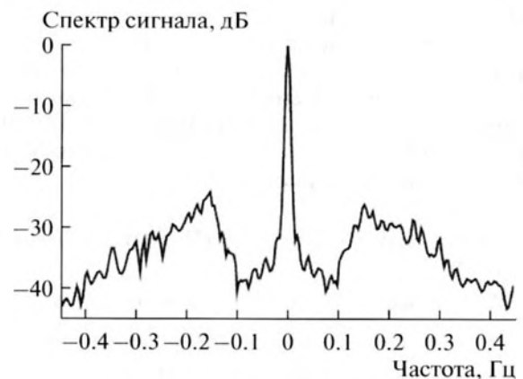
Рис. 4. Характерный частотный спектр принятого сигнала.
