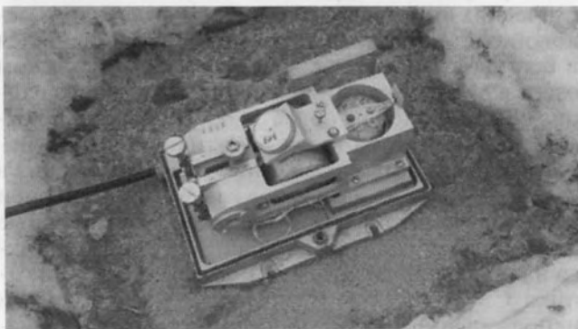
Рис. 7. Установка сейсмоприемника СМЗ-ОС в вырубке на поверхности льда.
