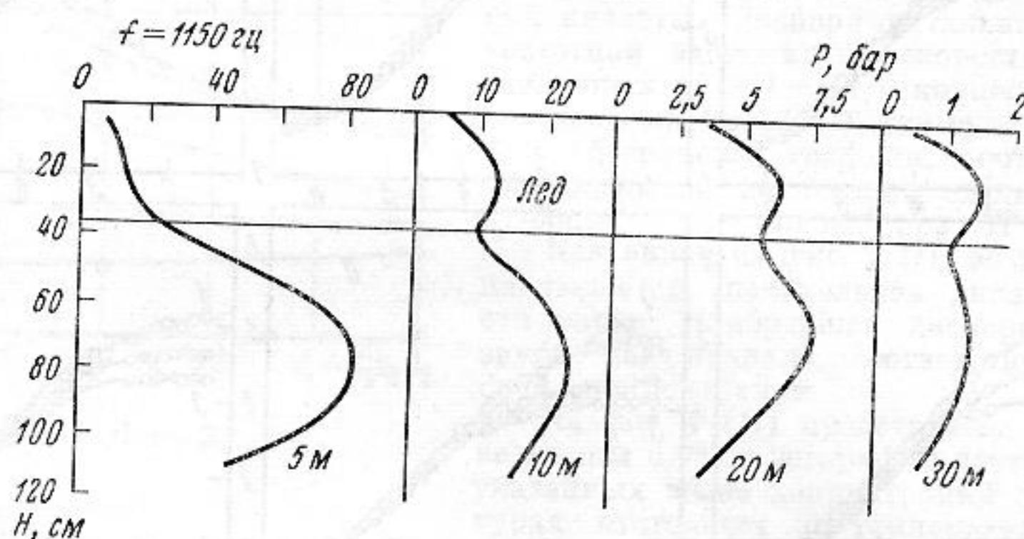
На фигуре приведены вертикальные распределения звукового давления, снятые на частоте 1150 Гц. Как следует из фигуры, звуковое давление в слое воды достигает максимального значения примерно на середине глубины слоя, уменьшаясь по мере приближения гидрофона ко дну и к нижней кромке льда. Уменьшение звукового давления около дна связано с влиянием на распространение звука газа в иллистом грунте; этот эффект рассматривался в работах [1–3].
